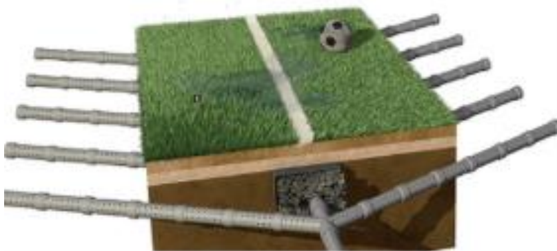
Figura 5 Sistema de drenagem por gravidade em espinha de peixe
